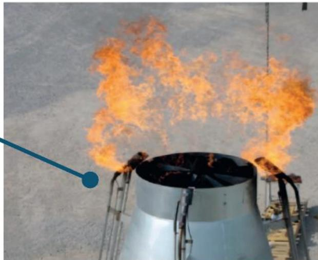
**Figure 7c :** Les buses d'injection de vapeur entourent la pointe de la torche assistée par vapeur
