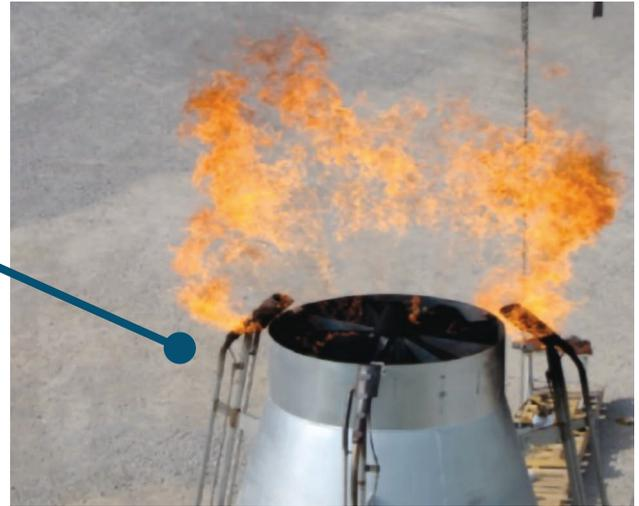
最近的研究<sup>11,12</sup>发现很难将烟雾最小化并保持燃烧效率, 特别是在废气的热值相对较低且火炬低负荷运行的情况下。通常可以通过熟练的操作来维持辅助率, 实现烟雾最小化和燃烧效率最大化。可以进行火炬运行方面的培训<sup>13</sup>, 但是对于固定辅助率的火炬, 例如在空气辅助火炬中使用定速鼓风机时, 要达到理想的火炬燃烧条件可能很困难<sup>14</sup>。
