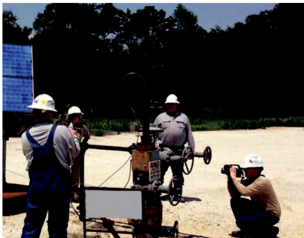
Figura 3: Uso de cámaras OGI
