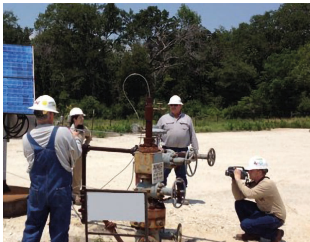
图3: 使用中的OGI摄像机
