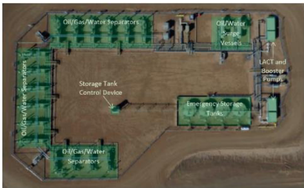
Figure 3 : Une installation de production utilisant une conception sans réservoir
