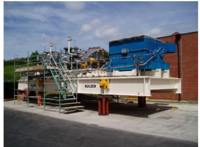
Figure 1 : Compresseur à gaz naturel
