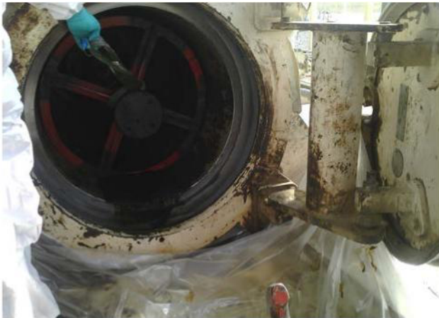
Figures 2a et 2b : Opérations de raclage
